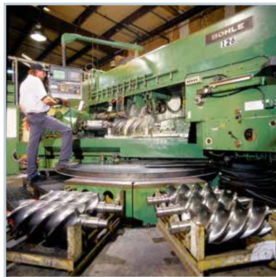
CycloBlower转子是采用精密铣削设备加工而成
